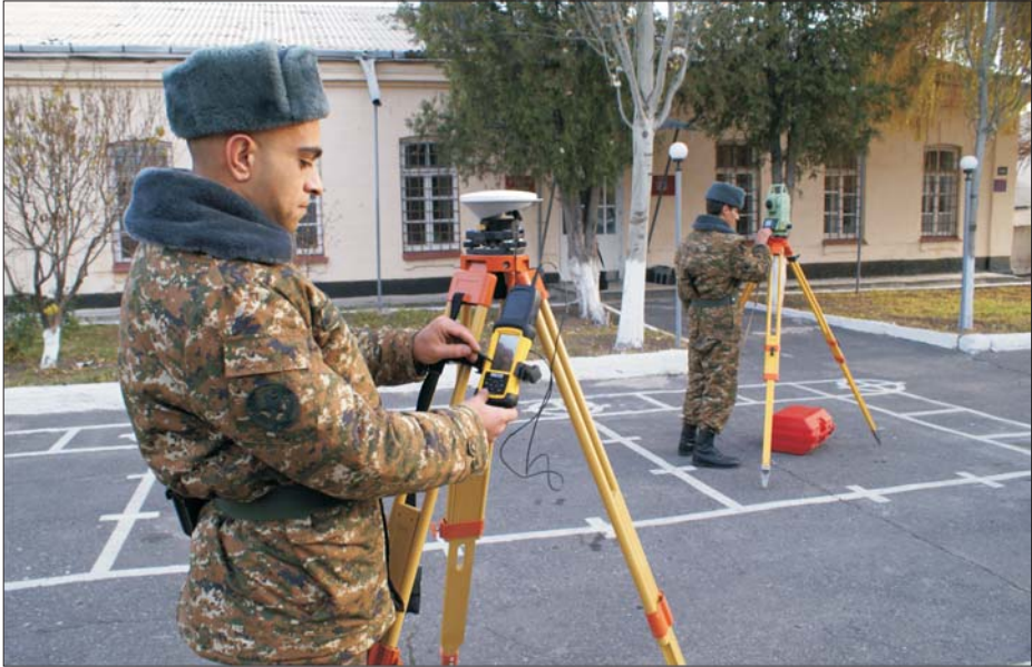
Չափագրման աշխատանքներ «Թրիմբլ Ռ-3» ուղեվարական ընդունիչի և «Լեյկա ԹՍՌ - 305» էլեկտրոնային հեռաչափի կիրառմամբ
