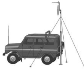
Նկ. 5. Շարժական հրամանատարական կետ՝ տեղեկության հոսքերի երթուղավորման հնարավորությամբ
