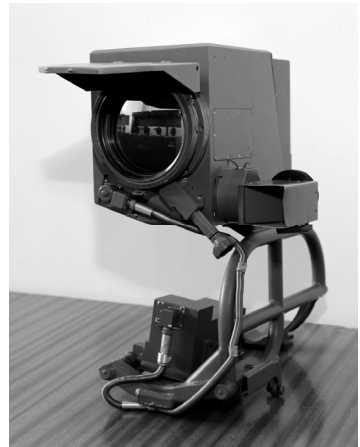
Նկ. 2. Ջերմադիտակային նշանոցի արտաքին տեսքը
