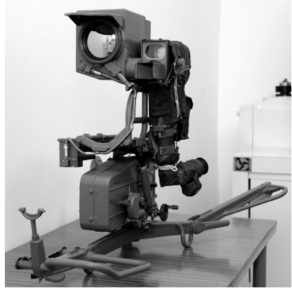
Նկ. 1. Ջերմադիտակային նշանոցը աշխատանքային դիրքում
